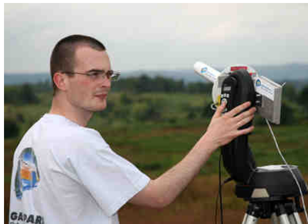
La réception du signal et des données est assurée par une antenne mobile du GAREF AEROSPATIAL positionnée et paramétrée par un jeune de l'équipe.
