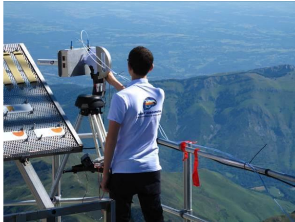
Figure 11 : L'antenne de réception en bande S
