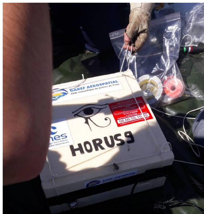
Figure 8 : Fixation de la nacelle sur la chaîne de vol
