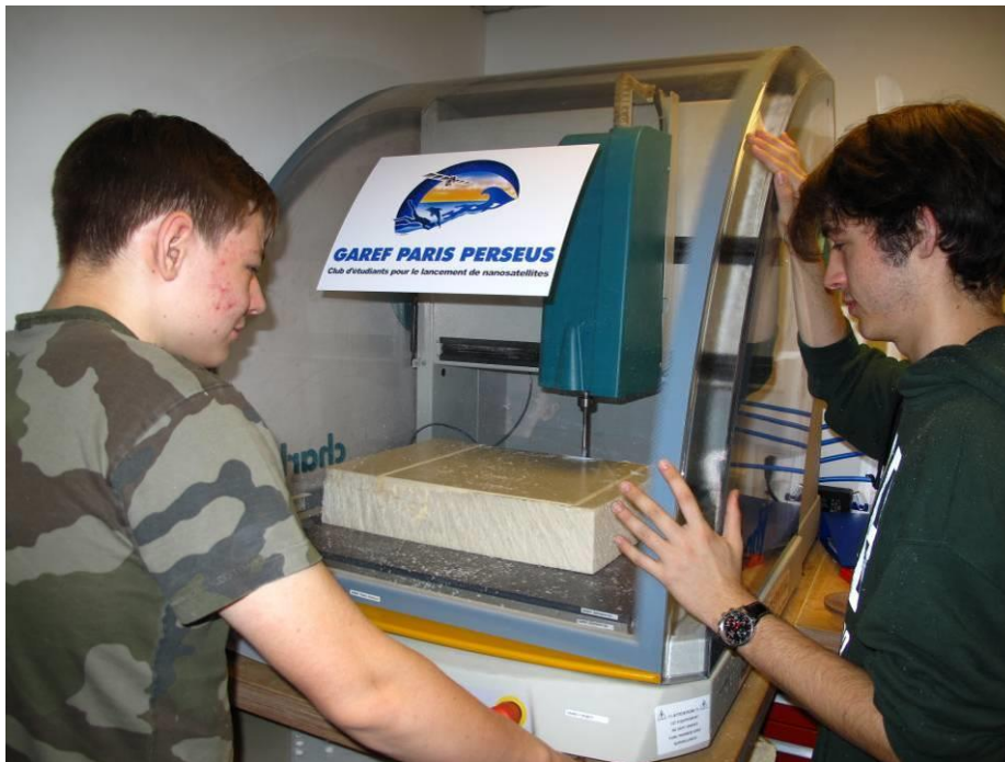
Figure 5 : Usinage d'un bloc de polystyrène extrudé
