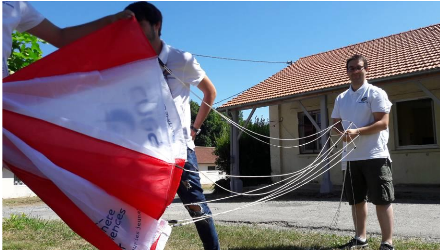
Figure 7 : Fixation des sustentés et de l'anneau anti-torche au parachute
