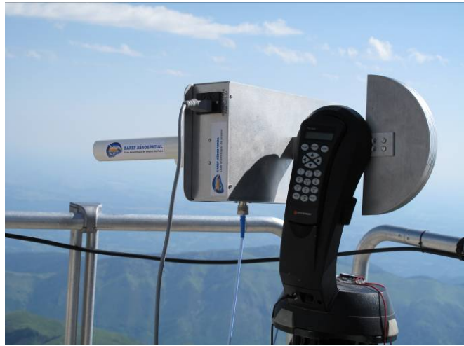
L'antenne de réception en bande S (Photo G180009. Photo GAREF PARIS)
