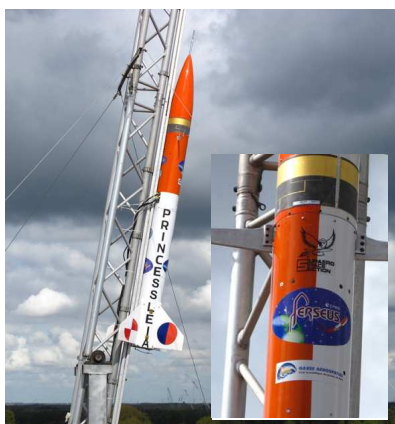
ARES 15 sur sa rampe de lancement (avec en gros plan l'antenne de peau en bande S, GAREF) ainsi que les équipements pied de rampe construits par le GAREF.
