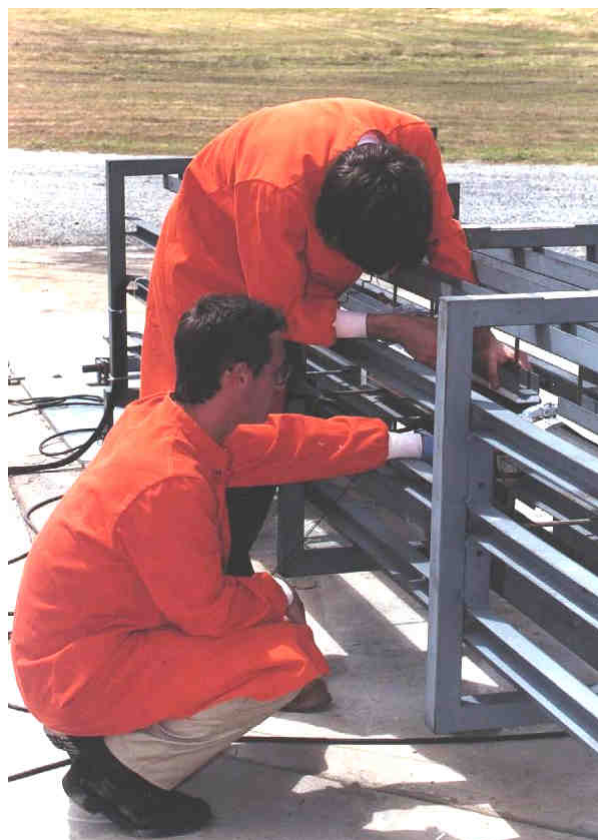
Site Fusée-Sonde, Vérification des cordons ombilicaux.
