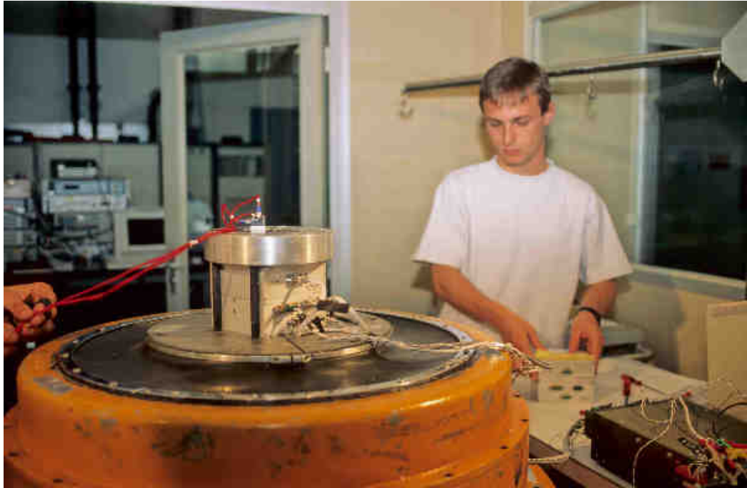
LRBA Vernon. Essais en vibrations du séquenceur pyrotechnique.
