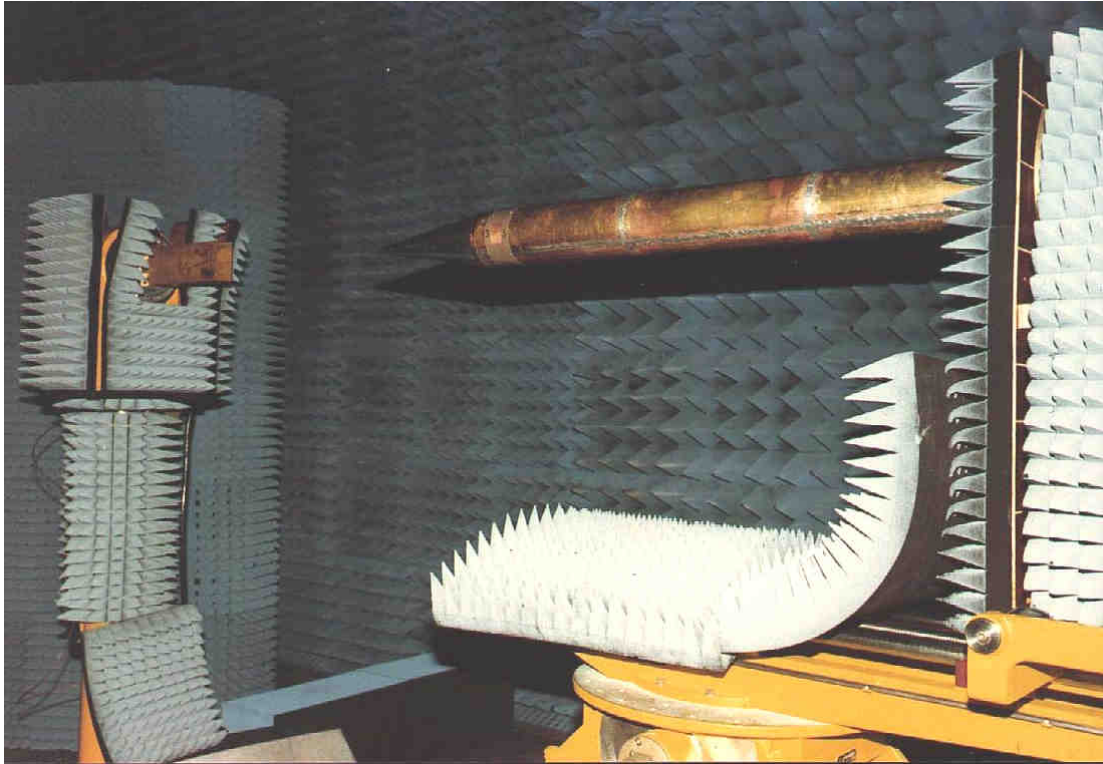
CNET La Turbie. Test des antennes de peau en chambre anéchoïde.
