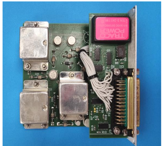
Carte d'alimentation avec ses trois relais auto-verrouillables aux normes Ariane
