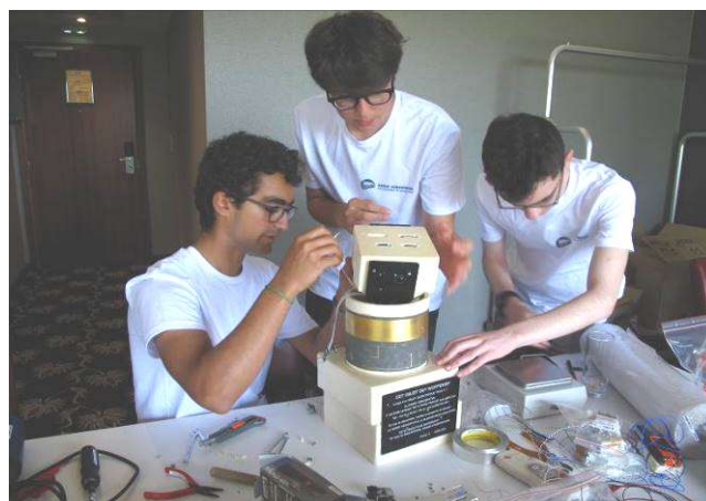
Derniers ajustements sur la nacelle du ballon-sonde Horus 11 qui cette année était en mousse usinée en CAO au GAREF.
