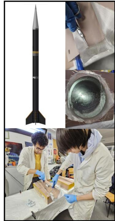
*En haut à gauche modélisation 3D de Zénith ; sur les photos : fabrication par les jeunes d'un prototype de la coiffe en matériaux composites.*
