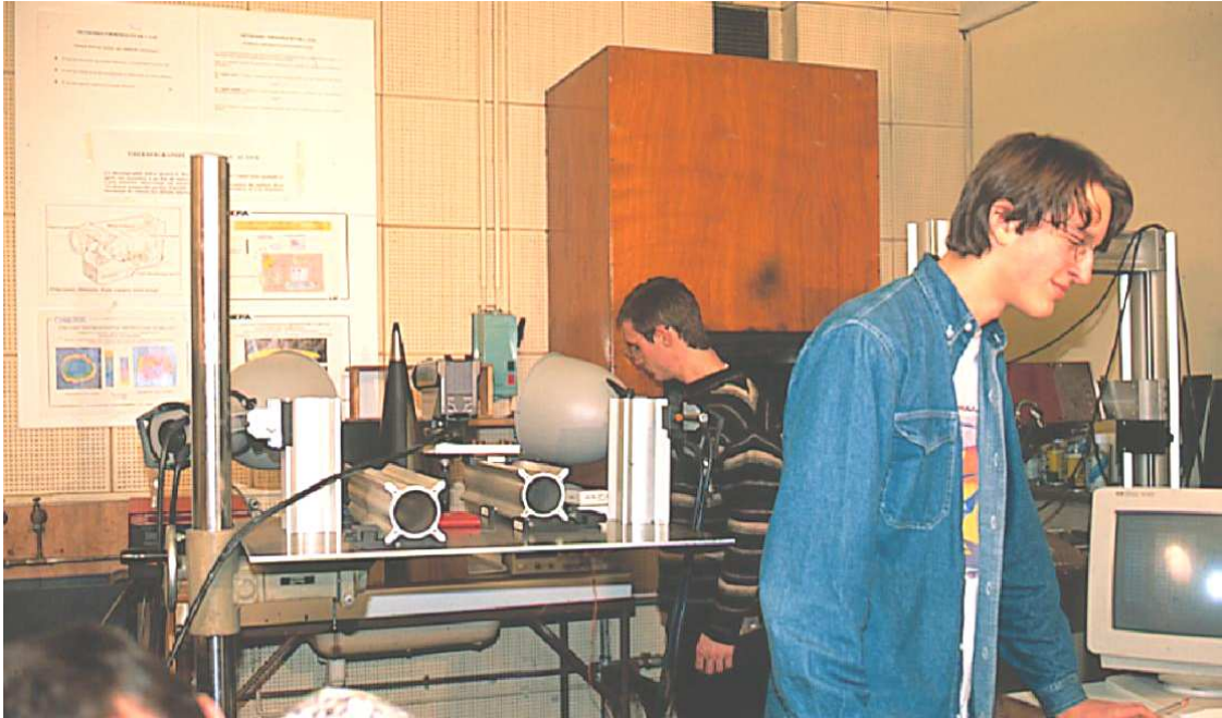
ONERA Chatillon. Mesure de la réponse impulsionnelle des capteurs de température du cône.
