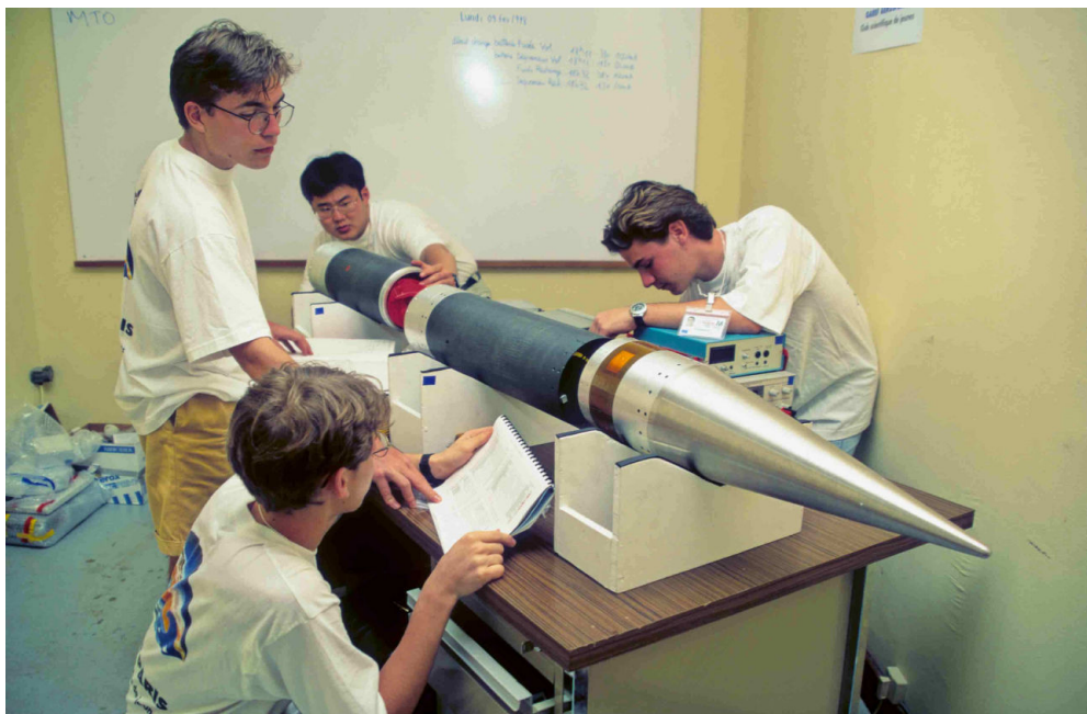
CSG. Site Fusée Sonde. Au CDL, vérification de l'assemblage de la charge utile. (l'assemblage final sera fait sur rampe le lendemain)
