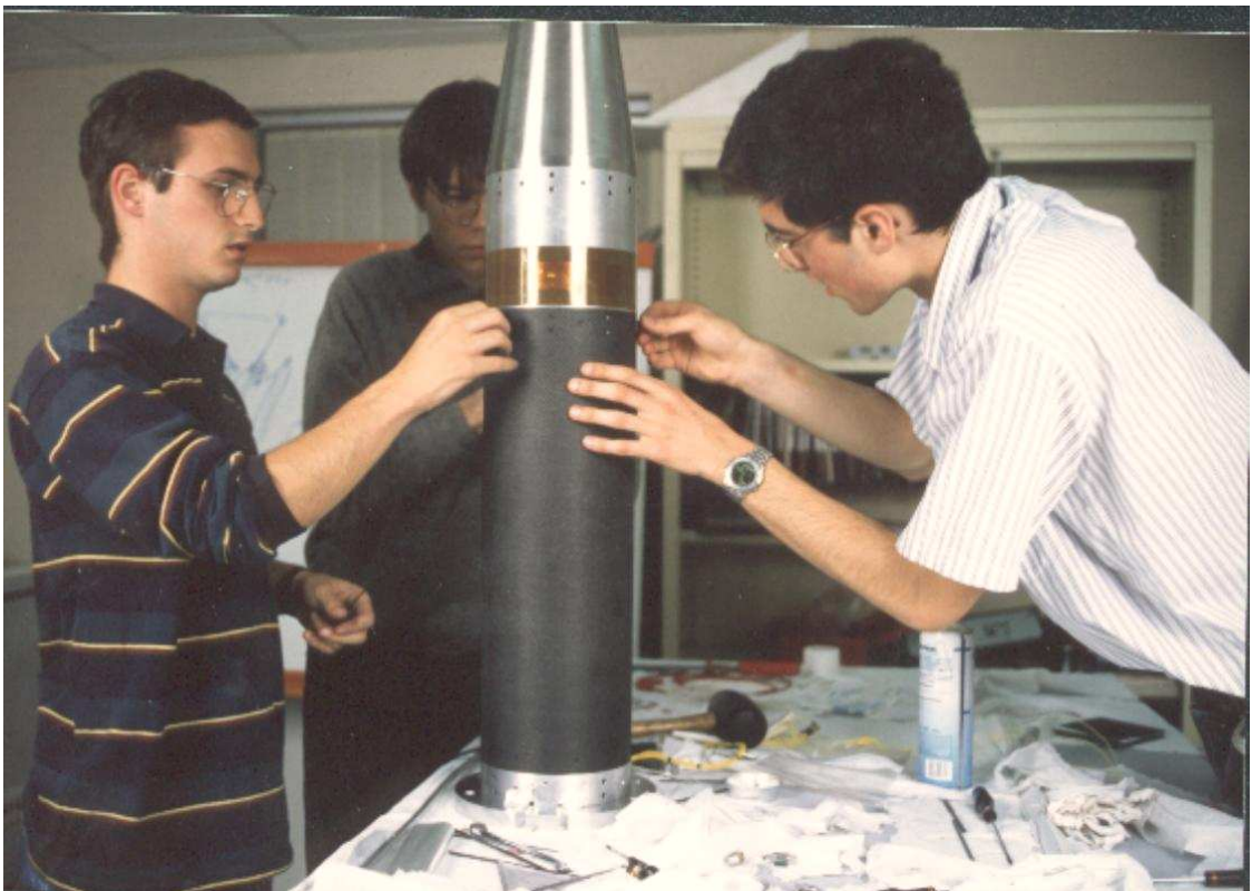
GAREF Paris. Montage mécanique de la case équipements.
