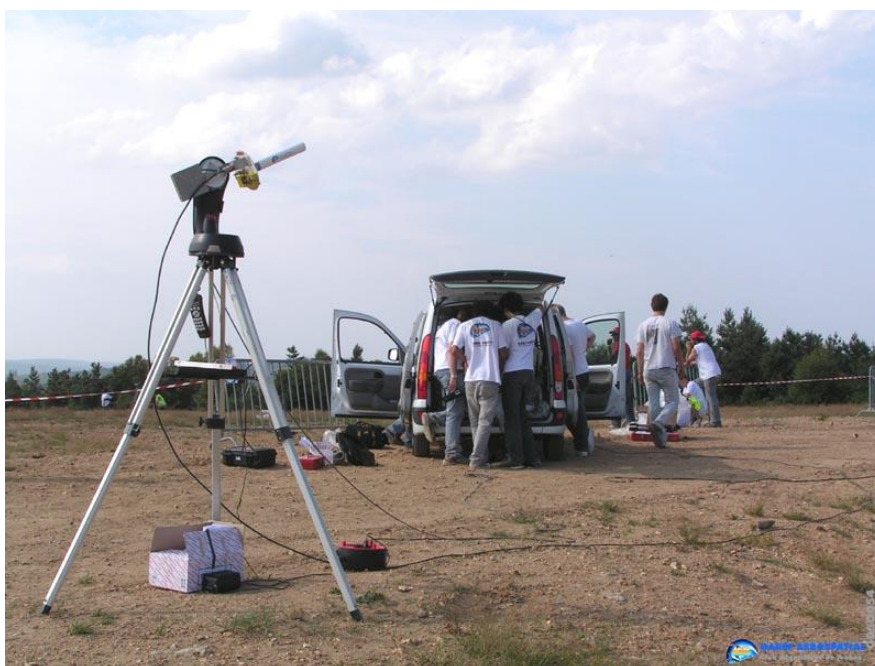
G050054 Antenne bande S et station de réception installée dans la Kangoo
