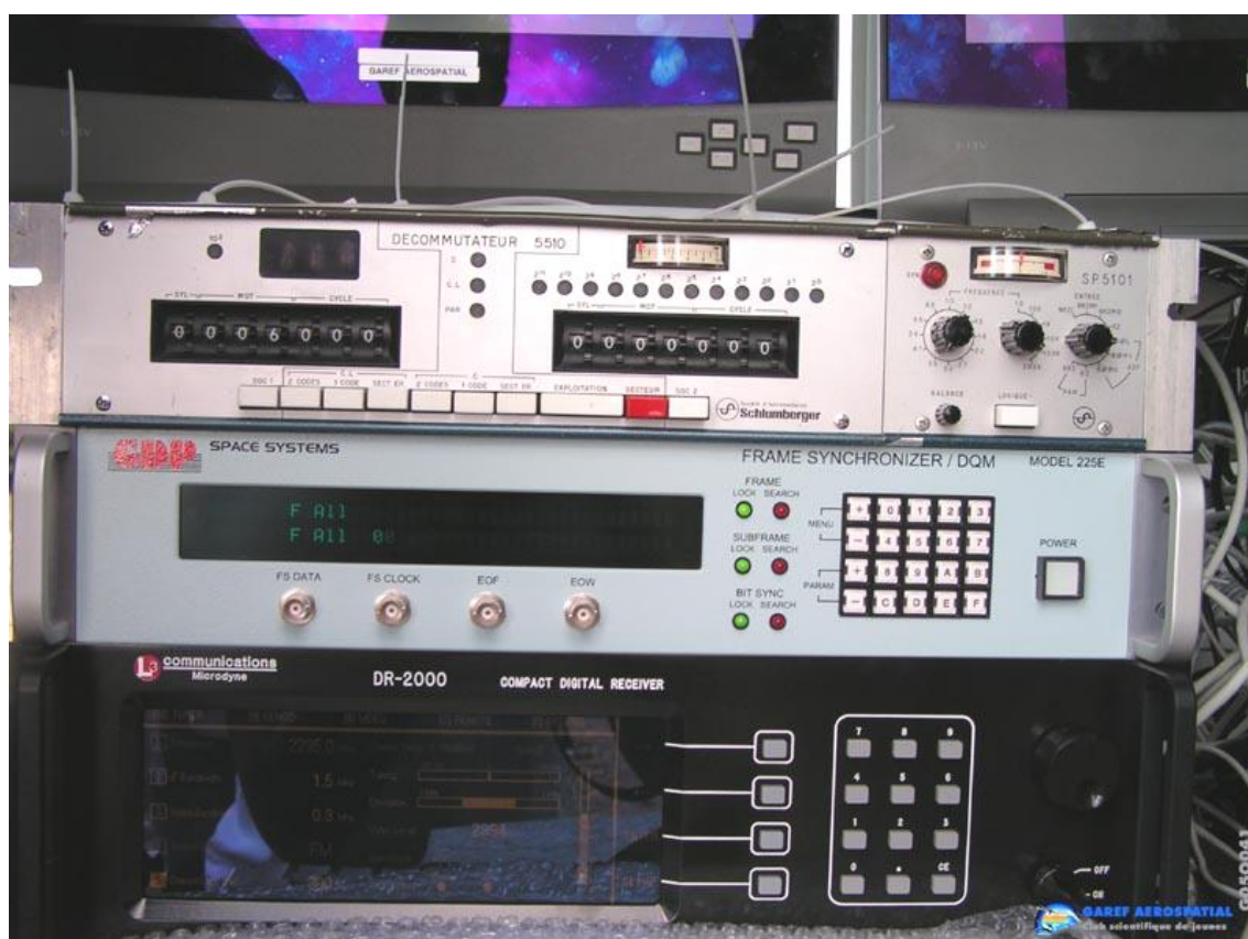
G050041 Le récepteur et les synchos primaire et secondaire
