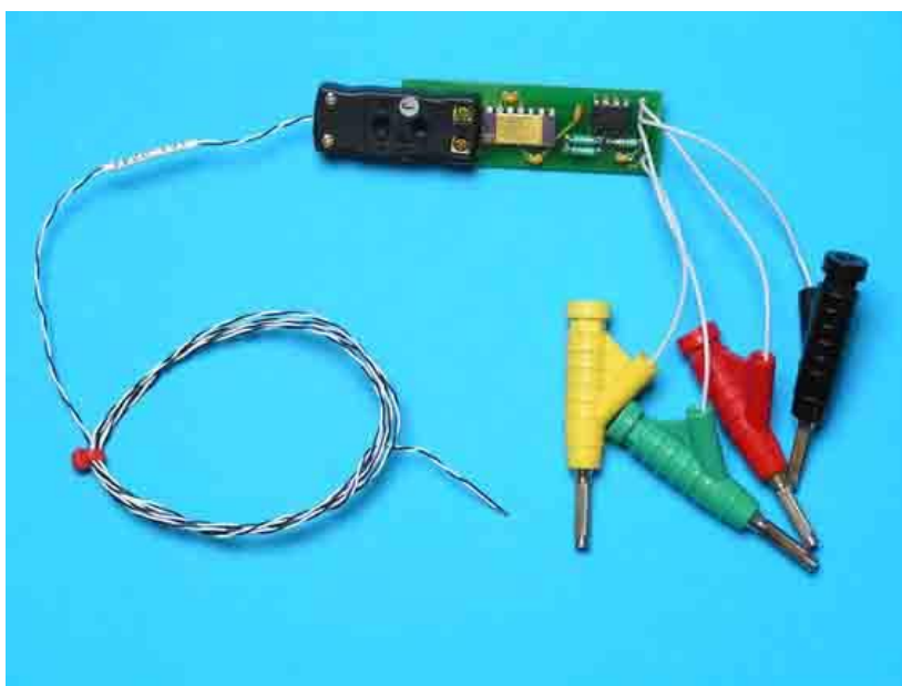
Module capteur de température avant blindage (Photo G07R205 Photo GAREF PARIS)
