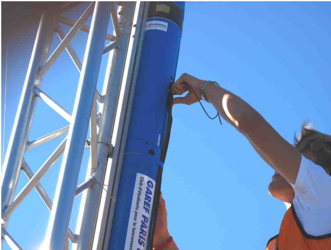
Photo GAREF PARIS G10P069 mise en place des ombilicaux
