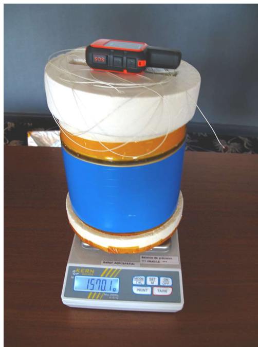
Figure 2 : Pesée de la nacelle complète
