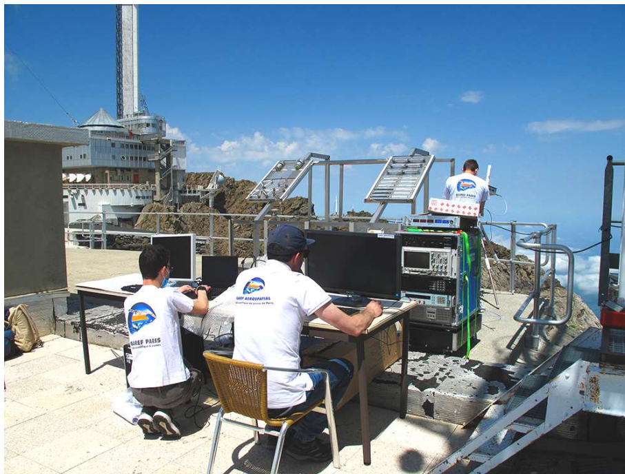
Figure 9 : La station de réception bande S sur une terrasse de travail de l'observatoire du Pic du Midi
