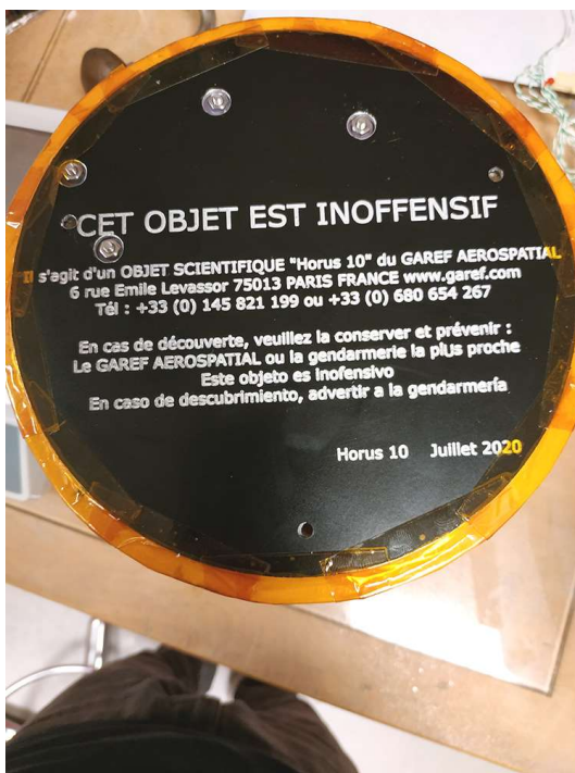
Figure 7 : Plaque de dissipation thermique de l'émetteur, avec un texte donnant les coordonnées du GAREF
