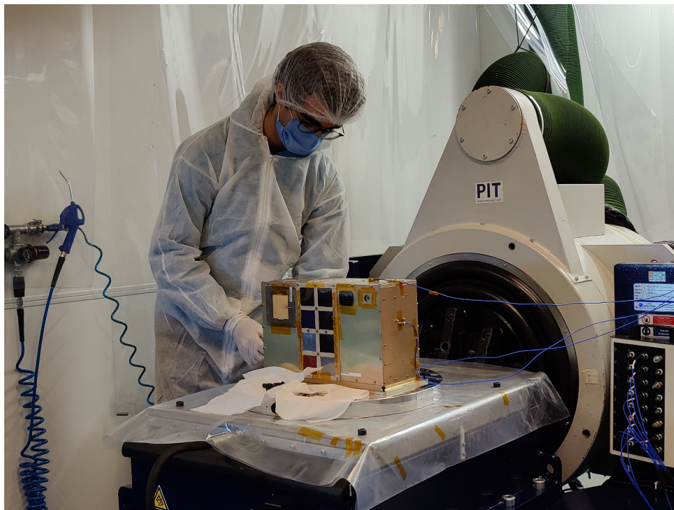
Fig. 4 . – Essai en vibration de PariSat à la PIT (OVSQ)
