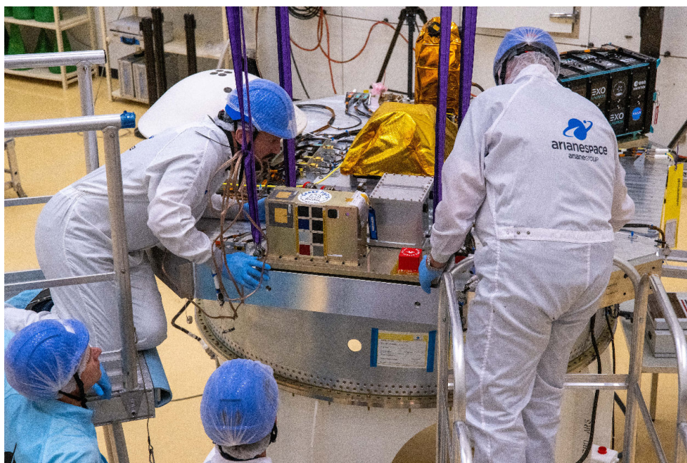
Fig. 7 . – Intégration de PariSat sur le ballast FM1 d'Ariane 6
