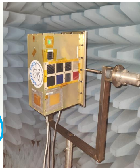
PariSat lors d'un essai de télémesure en chambre anéchoïque à l'ENSEA
